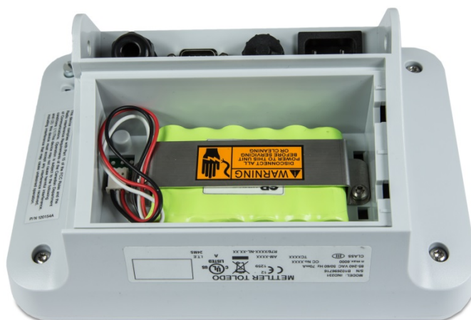
Figure 2-21: Batterie NiMH installée dans l'IND231
