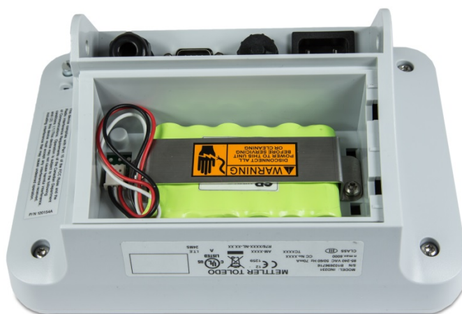
Figura 2-21: Bateria NiMH instalada no IND231
