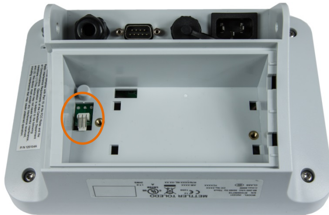
Figura 2-19: Retiro de la cubierta de la batería
