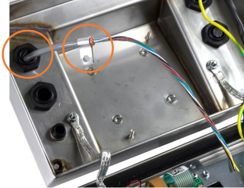
Figura 2-29: Passaggio del cavo della cella di carico nella scocca del terminale IND236, con il fermaglio di terra.
