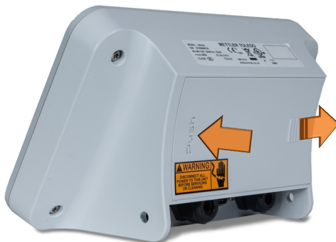
Figura 2-19: Remover a tampa da bateria
