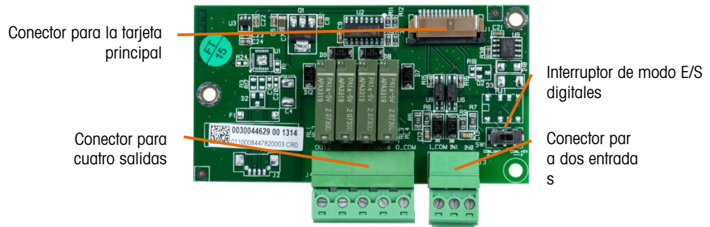
Figura 2-40: Tarjeta opcional de E/S discretas
