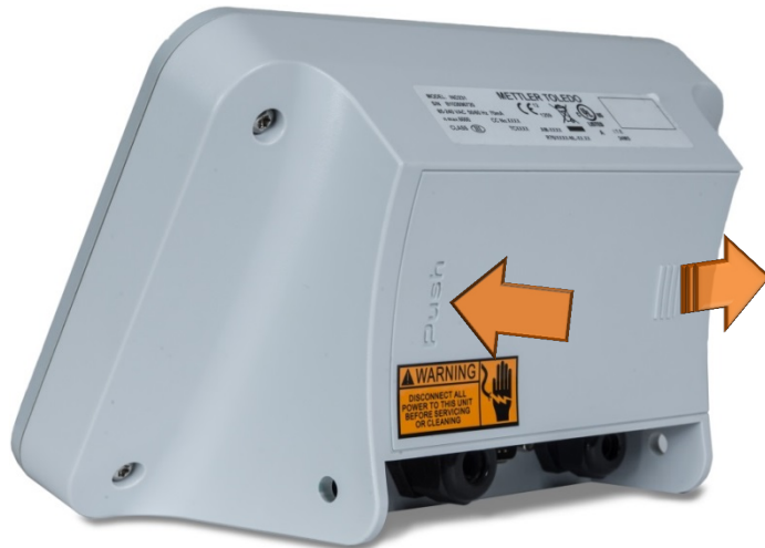
Figura 2-19: Retiro de la cubierta de la batería
