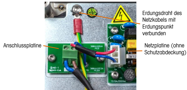
Abbildung 2-18: IND236 – Netzplatine und Erdung
