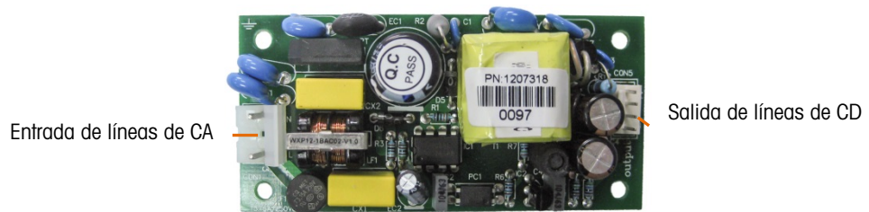
Figura 2-17: Tarjeta de energía
