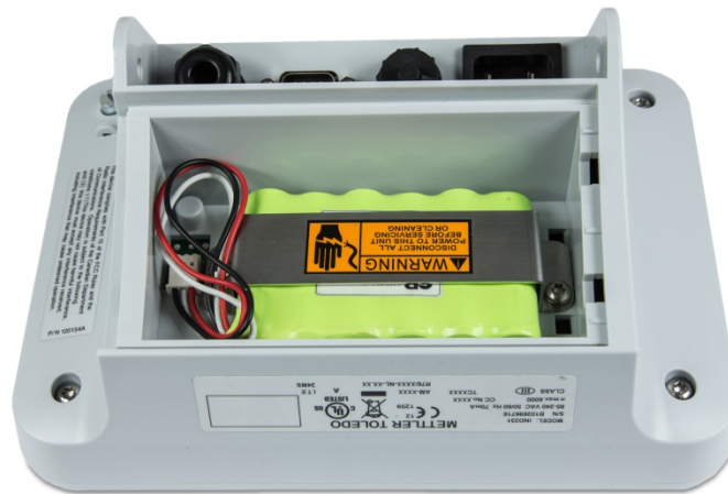
Abbildung 2-21: Im Terminal IND231 eingesetzte NiMH-Batterie
