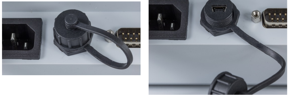
Figura 2-39: Conector mini USB y tapón
